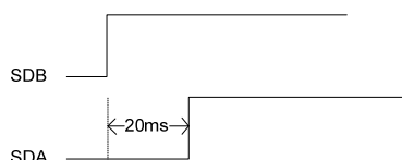
图 3 升压使能 SDB 与音频使能 SDA 上电时序
